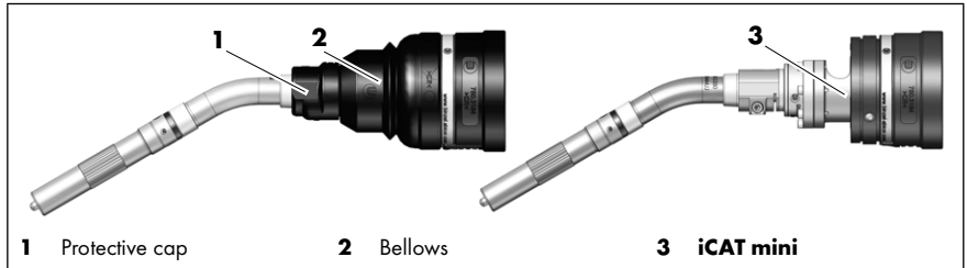
Fig. 15 Cleaning - iCAT mini for ABIROB® G
